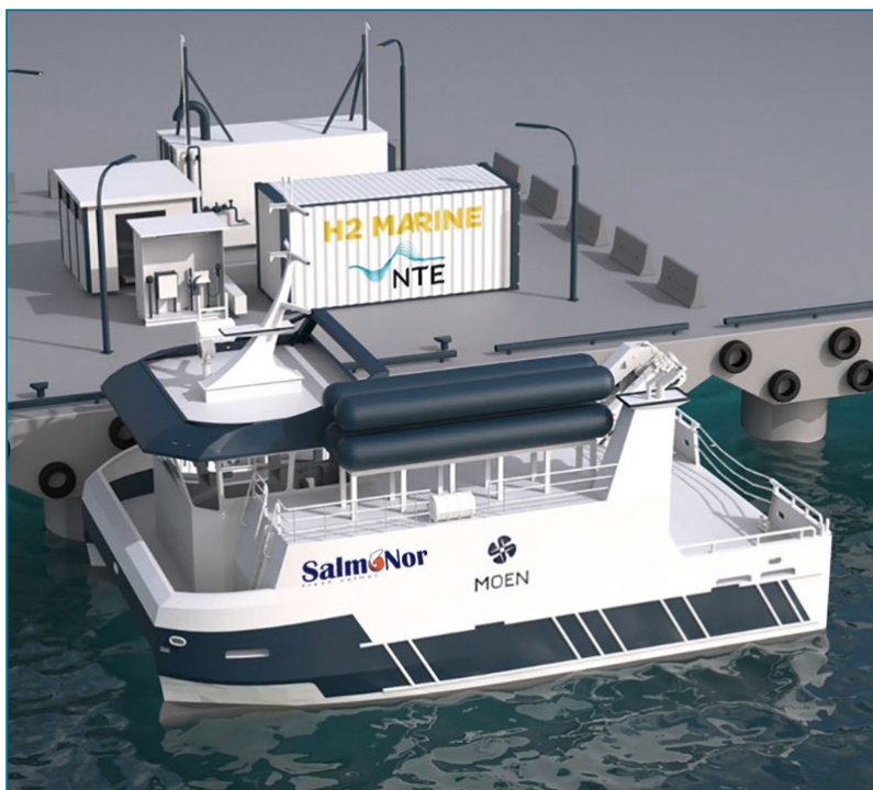
Prosjektet «Utslippsfri arbeidsbåt for havbruk» (UBÅT) skal utvikle og realisere en hydrogenelektrisk arbeidsbåt til havbruksnæringen, samt en komplett løsning for fleksibel forsyning av grønt hydrogen som drivstoff. Illustrasjon: H2 Marine
