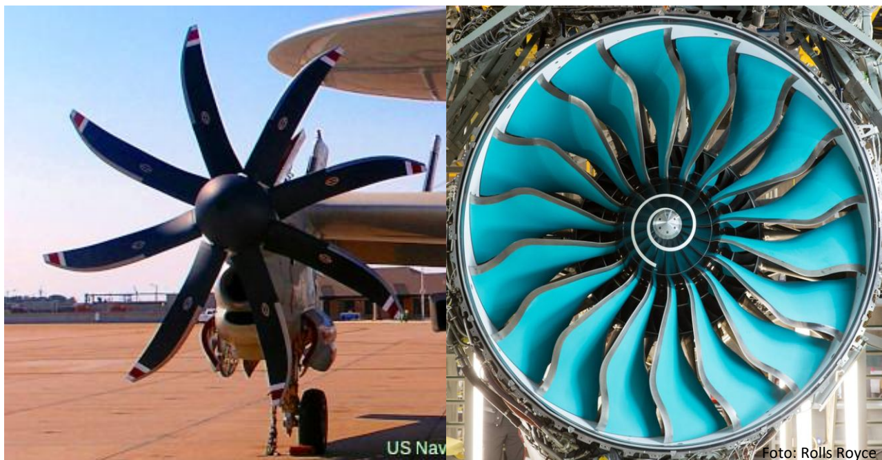
Figur 12: Propell (venstre) og turbovifte (høyre). Den åpenbare forskjellen er at en propell har færre blader og mangler innkapsling. De fungerer prinsipielt likt, men er designet forskjellig ved at de fungerer effektivt for ulike flyhastigheter og rotasjonshastighet.
