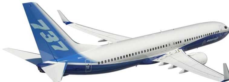
Figur 3: Boeing 737NG, med winglets (de bøyde vingtuppene), nye CFM motorer, nye materialvalg og andre oppgraderinger sammenlignet med den opprinnelige 737 fra 1968 (bilde: Boeing).
