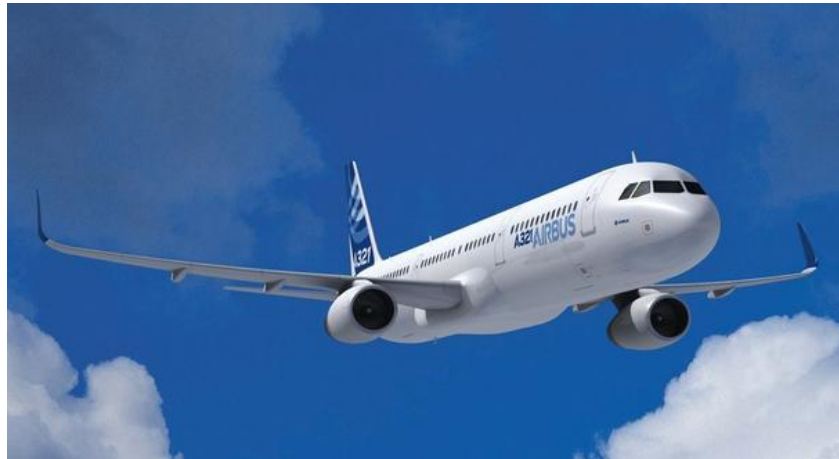
Figur 2: Airbus A320 neo-familien har flere oppgraderinger fra den opprinnelige A320 med sharklets på vingene, nye motoralternativer og flere oppdateringer i flykroppen og kabinen (bilde: Airbus).
